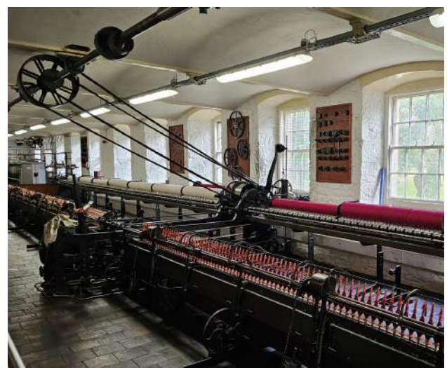
Fig. 21: Máquina hiladora y correa de transmisión en la parte superior izda. en el interior de New Lanark
