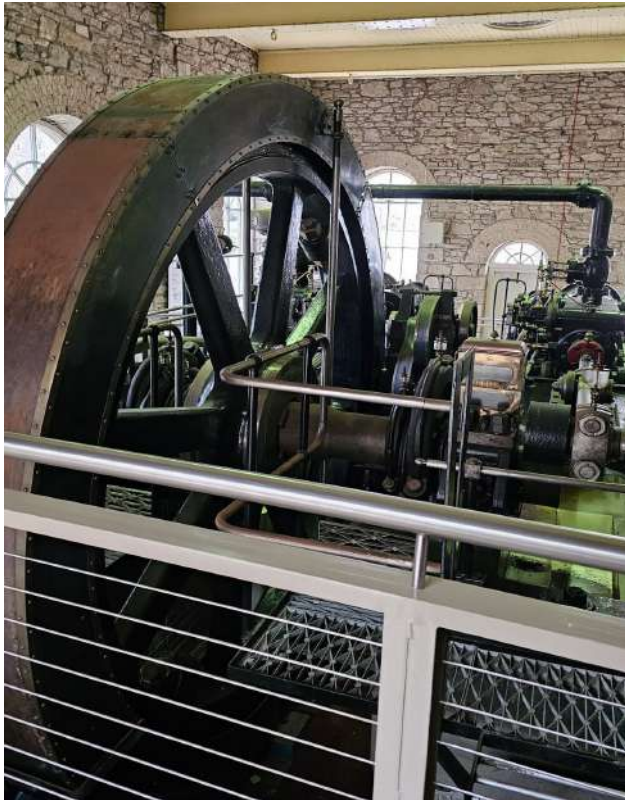
Fig. 19: Máquina de vapor, en el anterior complejo de New Lanark. Ayudaba a la producción complementando la energía hidráulica
